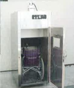
介護用品の蒸気除菌乾燥装置
